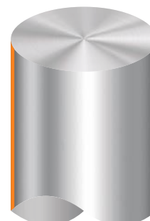
Chropowatość trzpienia Ra \leq 0,3 \mu m
