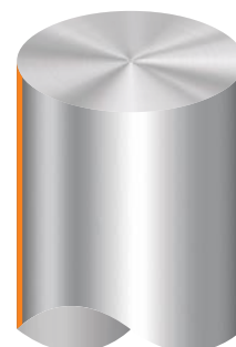
Chropowatość trzpienia Ra \leq 0,3 \mu m
